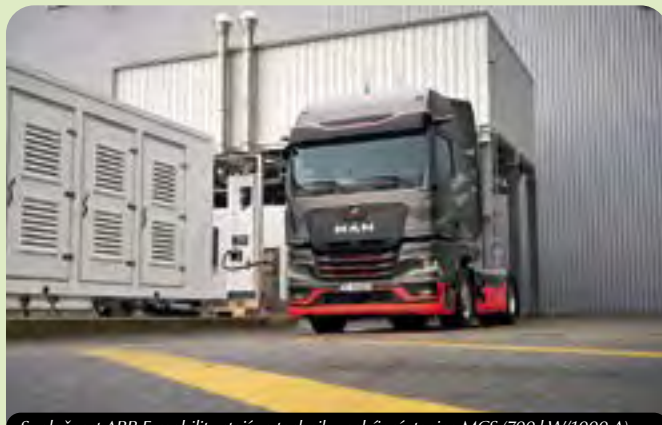
Společnost ABB E-mobility stojí za technikou nabíjecí stanice MCS (700 kW/1000 A)
